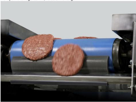
Die Abstreiferblätter können einfach montiert, gespannt und ausgewechselt werden (Bild: Flexco Europe).
