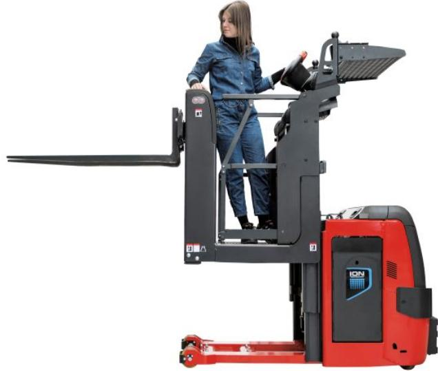
Der Vertikalkommissionierer verfügt über einen Zusatzhub mit 800 kg Tragfähigkeit (Bild: Linde Material Handling).
