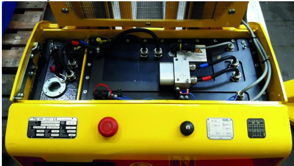
Die neue Batterie für Flurförderzeuge, die in den Zonen 1 (2G) und 21 (2D) eingesetzt werden (Bild: Stöcklin Logistik).
