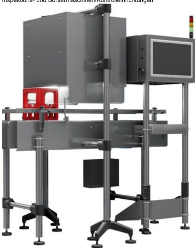
Die Bildverarbeitungssysteme werden bereits von namhaften Logistikbetrieben bei der Leergutrücknahme eingesetzt (Bild: BBull Technology).
