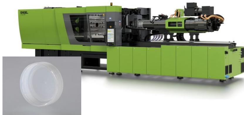
Die neue Spritzgießmaschine für die Caps-and-Closures-Industrie bietet Zykluszeiten von unter 2 s (Bild: Engel Austria).
