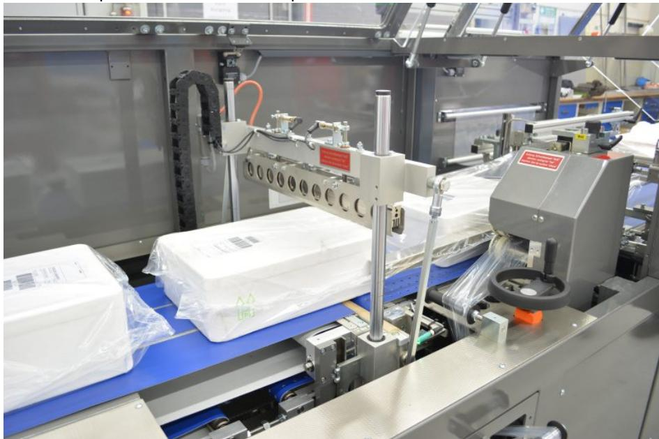
Mithilfe der Folienverpackungsmaschine kann der verpackte Fisch seine Reise um die Welt antreten (Bild: Kallfass Verpackungsmaschinen).
