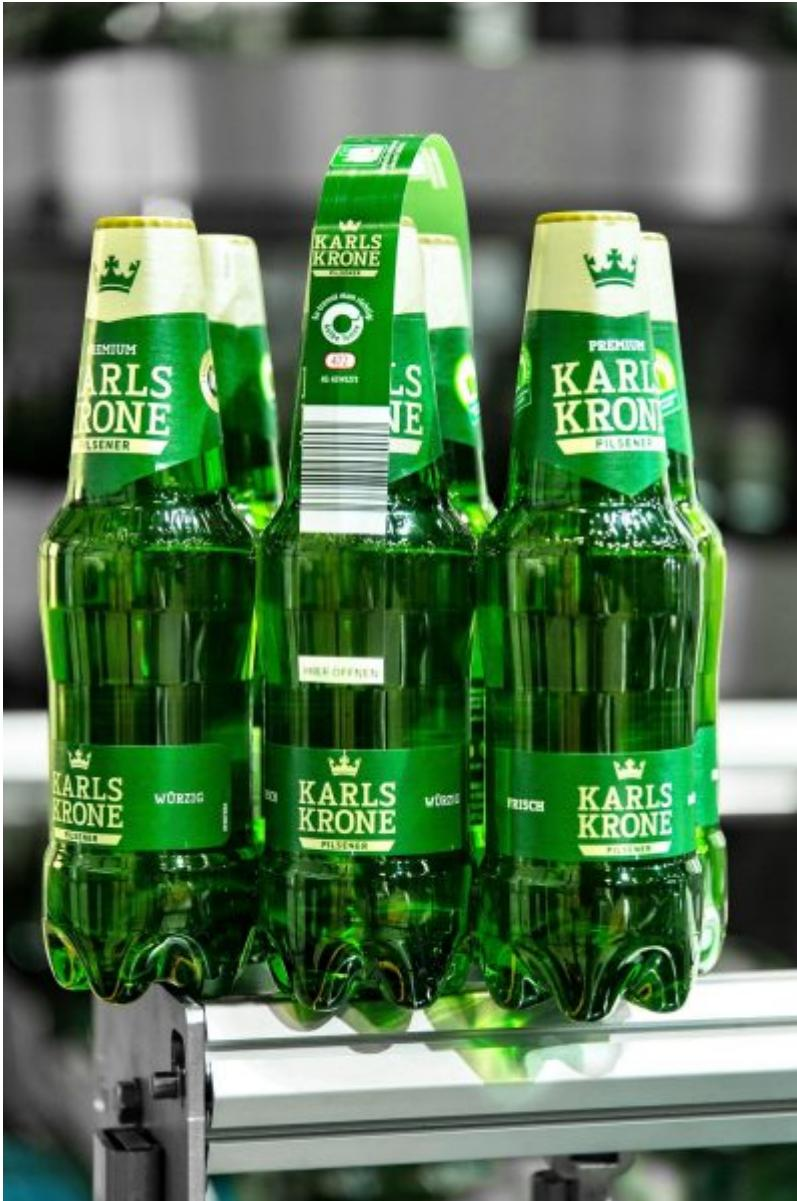
Statt Schrumpffolie verbinden nur noch durch Klebepunkte die Flaschen zu einem stabilen Gebinde (Bild: KHS).
