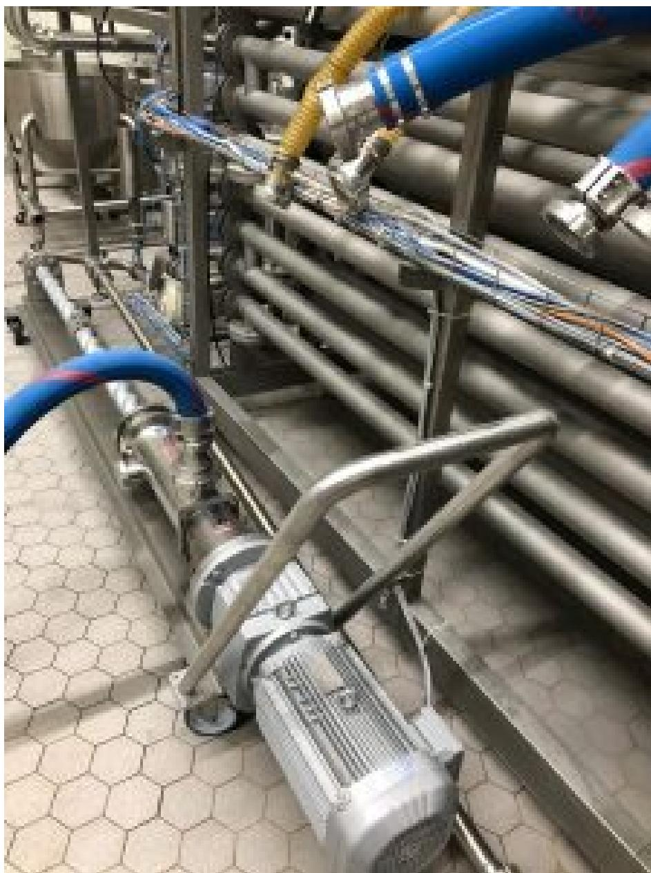
Beim Gewürzhersteller Lay werden mithilfe der Exzentrerschneckenpumpen viskose Gewürzmischungen pasteurisiert (Bild: Pumpenfabrik Wangen).
