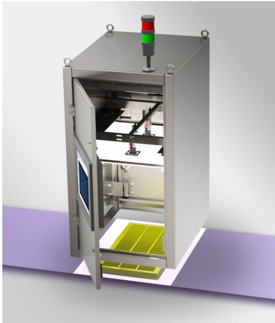
Hochauflösende GigE-Farbkameras erfassen selbst kleinste Produktreste in Leerformen (Bild: Bi-Ber).
