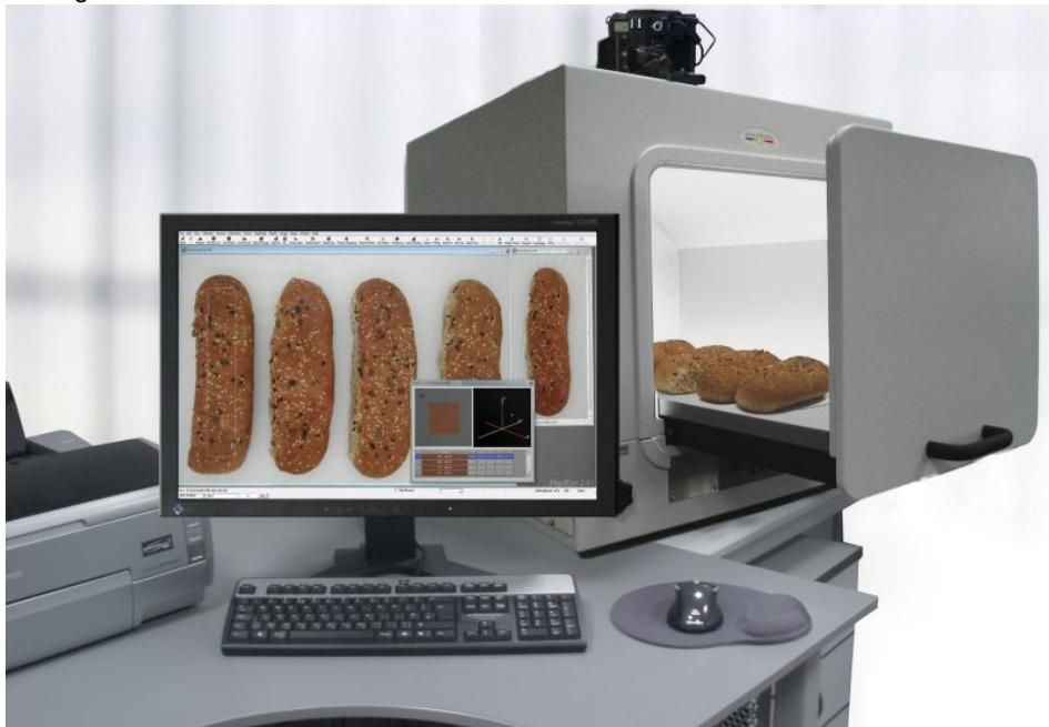
Auch optisch heterogene Produkte können mit der digitalen Farbmessung geprüft werden (Bild: Carl von Gehlen).
