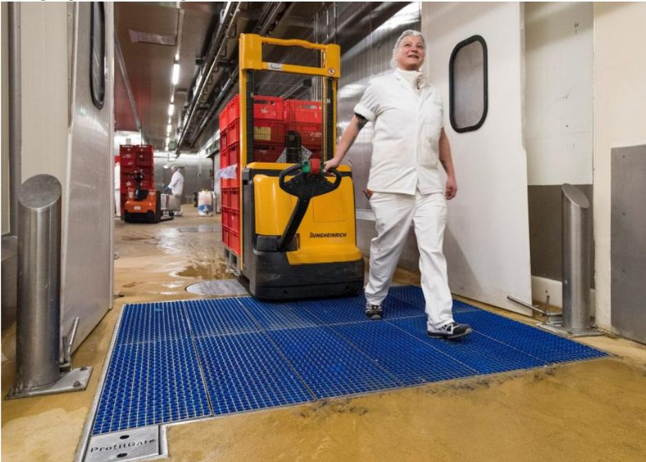
Die Reinigungsfelder stoppen Mikroorganismen, noch bevor diese in die Produktion gelangen können (Bild: Heute Maschinenfabrik).
