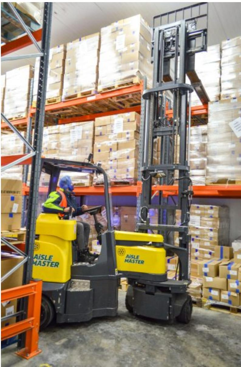
Der Lagerraum konnte dank des Stapler-Designs und seiner Fähigkeit, in schmalen Gängen und auf engem Raum zu arbeiten, optimiert werden (Bild: Combilift).
