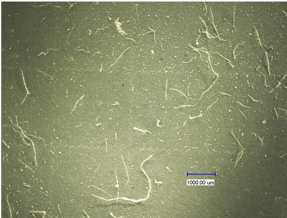
Faserkontamination einer Hauptlauge, Membranfiltration (Bild: Ecolab).
