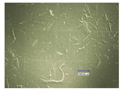
Faserkontamination einer Hauptlauge, Membranfiltration (Bild: Ecolab).
