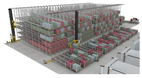
Bei den Hochleistungsanlagen aus einer Hand entfällt die übliche Schnittstellenproblematik zwischen den angetriebenen und den auf Schwerkraft ausgelegten Systemen. Bilder: Interroll
