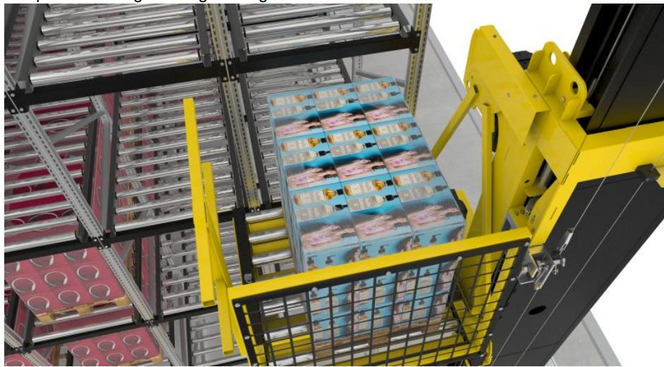
Mit dem Einsatz von Regalbediengeräten in Leichtbauweise, den Verfahrwagen und Liften lassen sich bei Modernisierungsprojekten Durchsatz und Kapazität von bestehenden Fließlagern steigern (Bild: Interroll).
