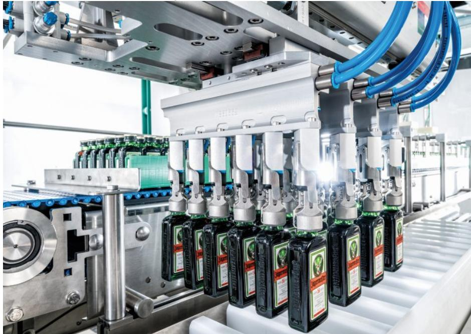
Schnell und flexibel kann die neue Maschine bis zu 750 »Mini Meisters« pro Minute in 24er-, 9er- und 10er-Losgrößen verpacken (Bild: Schubert).
