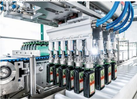
Schnell und flexibel kann die neue Maschine bis zu 750 »Mini Meisters« pro Minute in 24er-, 9er- und 10er-Losgrößen verpacken (Bild: Schubert).
