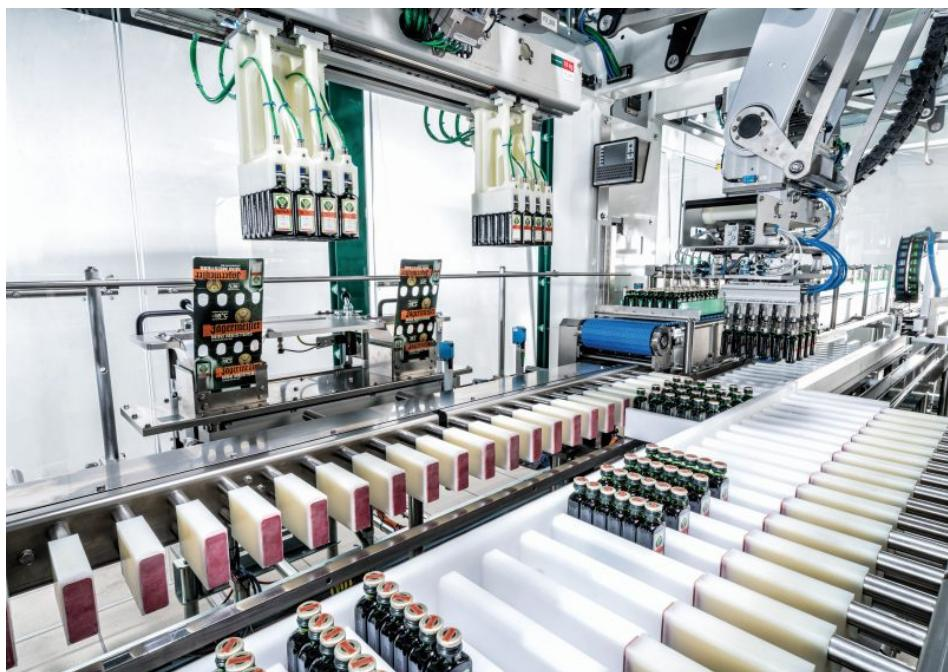
Die flexible und auf das neue Verpackungskonzept angepasste Verpackungsmaschine ersetzt vollautomatisiert und präzise das bisherige Umpacken der kleinen Flaschen von Hand. Bilder: Schubert
