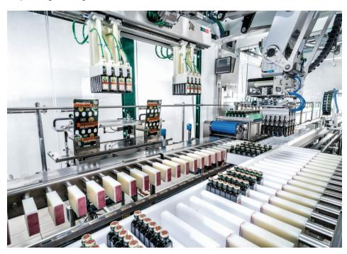
Die flexible und auf das neue Verpackungskonzept angepasste Verpackungsmaschine ersetzt vollautomatisiert und präzise das bisherige Umpacken der kleinen Flaschen von Hand. Bilder: Schubert
