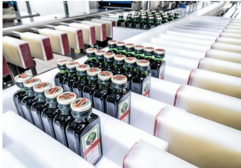
Die richtig orientierten Flaschen wurden von einem Roboter aus dem Bulk in eine Gruppierkette übergesetzt (Bild: Schubert).
