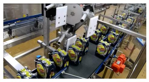
Der präzise Überschub schräg zur Laufrichtung erlaubt auch quer kommende Sixpacks in Folie exakt ausgerichtet auf die Parallelbahn zu verteilen. Bilder: Sortec
