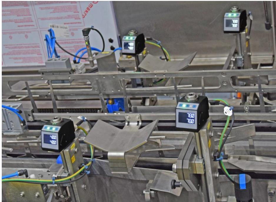
Bis zu 40 Verstellpunkte werden bei Formatwechseln mithilfe elektronischer Positionsanzeigen bequem und prozesssicher angepasst (Bild: Rovema).
