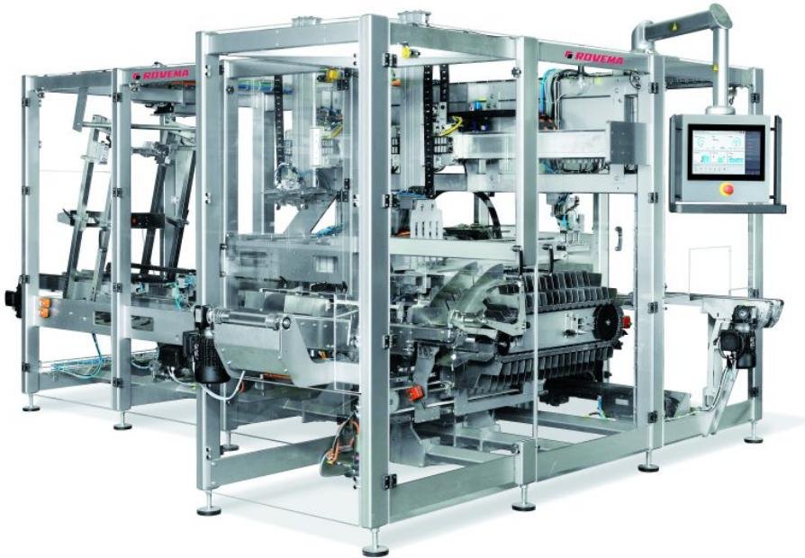
Die Endverpackungsmaschine für Trays mit Deckel ermöglicht einen besonders präzisen und produktschonenden Verpackungsprozess. Optional können elektronische Positionsanzeigen zur überwachten Formatverstellung integriert werden (Bild: Rovema).
