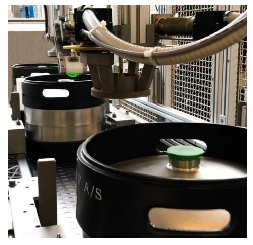
Die automatischen Kappenaufsetzer und -schrumpfer sind auch für eine Leistung von bis zu 2000 Kegs pro Stunde erhältlich (Bild: atka).
