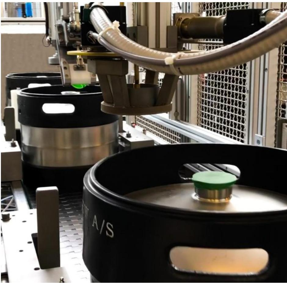
Die automatischen Kappenaufsetzer und -schrumpfer sind auch für eine Leistung von bis zu 2000 Kegs pro Stunde erhältlich (Bild: atka).
