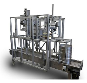
Der neue Kappenaufsetzer und -schrumpfer ermöglicht auch kleinen Brauereien die vollautomatische und zuverlässige Versiegelung von Kegs. Bilder: atka
