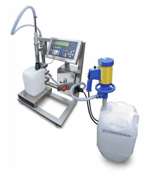
Dieser Abfüllanlagentyp ermöglicht das sichere und exakte Abfüllen per Handbedienung. Bild: Jessberger
