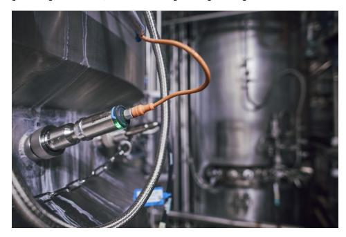
Das selbstkalibrierende Thermometer arbeitet mit einem integrierten Fixpunktsensor. Bilder: Endress+Hauser
