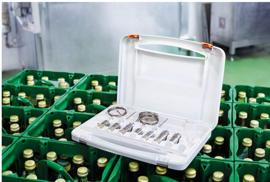
Die Datenlogger im Multifunktionskoffer sind aus rostfreiem Edelstahl und robustem PEEK gefertigt.
