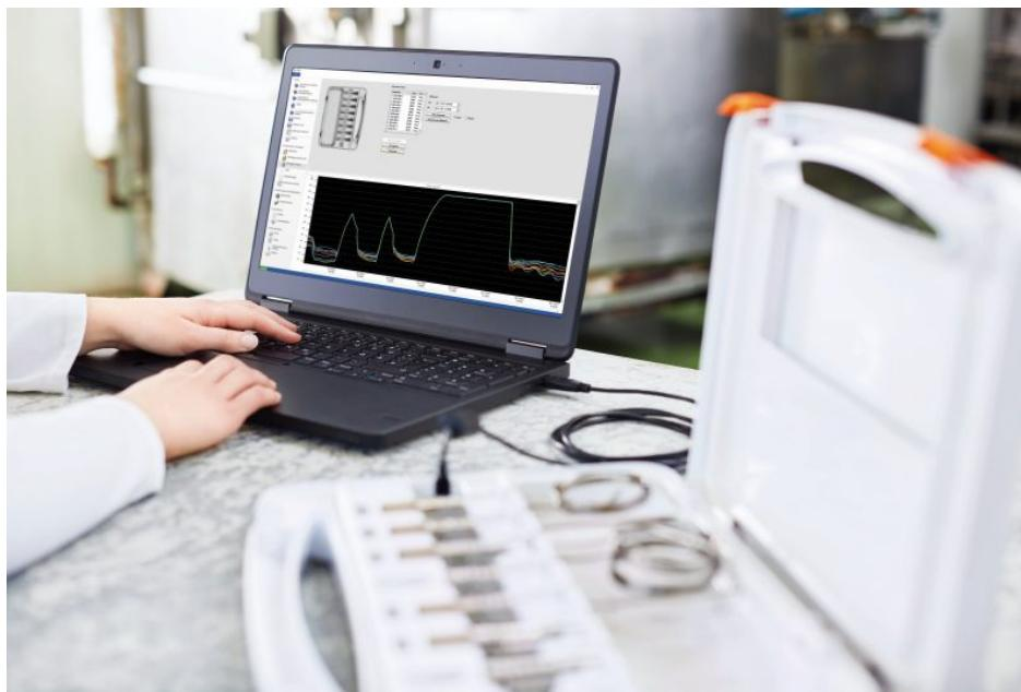
Der Transportkoffer fungiert nicht nur als Schutz, sondern wird dank integrierter Programmier- und Ausleseeinheit auch fürs Konfigurieren und Auslesen der Datenlogger verwendet.
