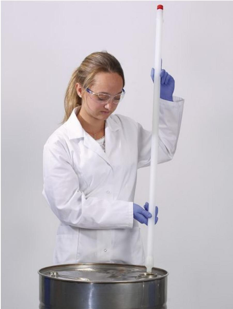
Dieser Probenehmer pumpt die flüssige Probe mittels Vakuum über den Saugschlauch direkt in die sterile Probenflasche.
