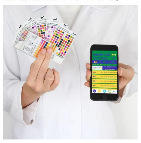
Schnell und genau: Die Messergebnisse der App in Kombination mit Teststreifen sind mit denen vergleichbar, die mit höherwertigen Geräten erreicht wurden. Bilder: Merck
