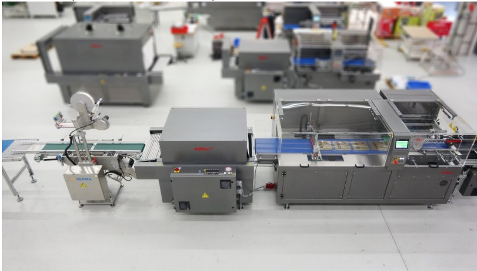
Verpackungsmaschine zur Verpackung und Etikettierung von Premiumschokolade (Bild: Kallfass).
