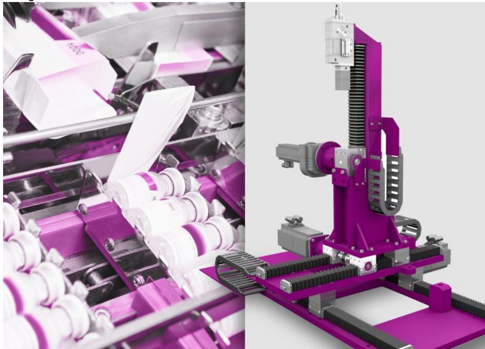
Zahnstangengetriebe und Positioniersysteme sind die Basis leistungsstarker Verpackungsanlagen (Bild: Leantechnik).
