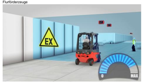
Das Stapler-Assistenzsystem ist auch für Ex-geschützte Flurförderzeuge der Zonen 2/22 verfügbar (Bild: Linde Material Handling).
