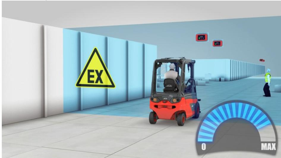
Das Stapler-Assistenzsystem ist auch für Ex-geschützte Flurförderzeuge der Zonen 2/22 verfügbar (Bild: Linde Material Handling).
