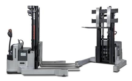
Die individuell konstruierten Reinraum-Flurförderzeuge bieten eine Tragkraft bis 2600 kg (Bild: Sichelschmidt).
