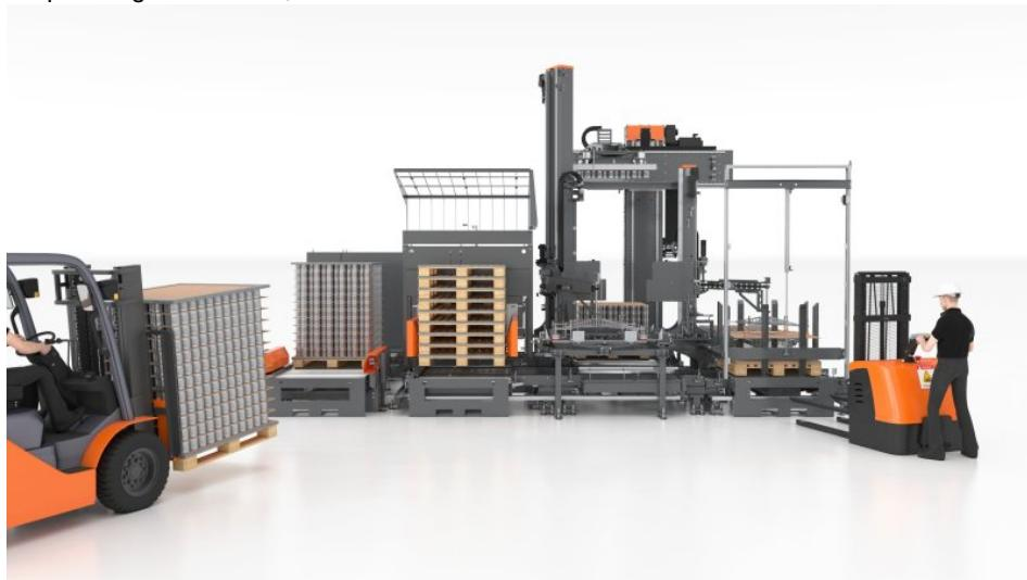
Ein Magnetgreifer mit integrierter Pneumatik-Magnetplatte nimmt die gesamte Dosenlage auf (Bild: Trapo).
