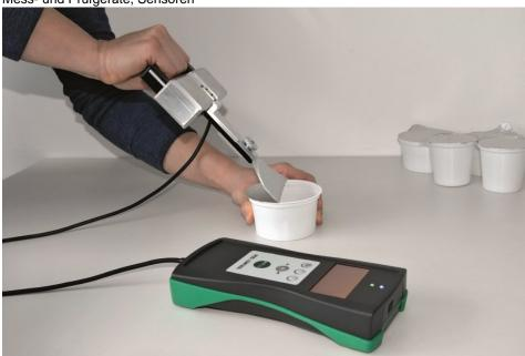
Das Trennkraftmessgerät ermittelt schnell und einfach die Öffnungskräfte von Verpackungen (Bild: Pitsid).
