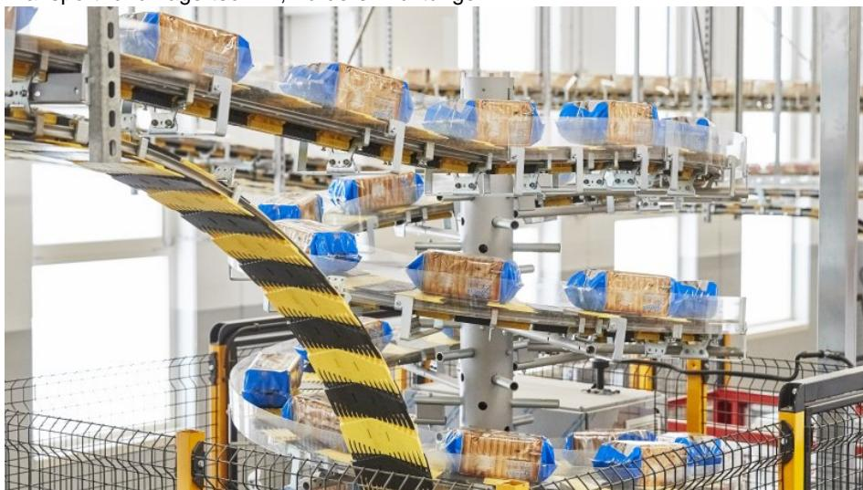
Die Fördersysteme bilden die effiziente Schnittstelle zwischen vorgelagerter Produktion und Palettierer (Bild: Ferag).
