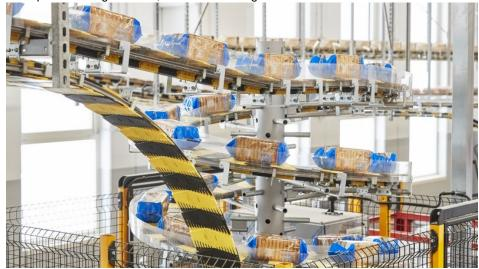
Die Fördersysteme bilden die effiziente Schnittstelle zwischen vorgelagerter Produktion und Palettierer (Bild: Ferag).
