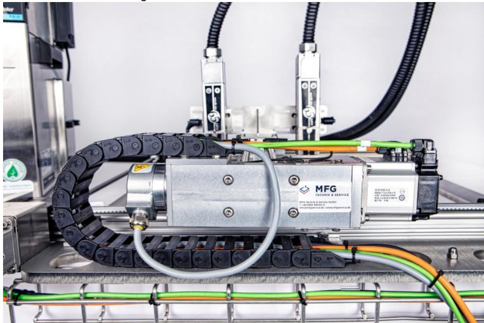
Der Druckkopf wird an einer Verfahrachse flexibel über die Oberfläche geführt, um den Arbeitsradius zu erweitern (Bild: MFG)
