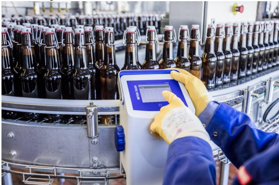
Mit dem Messgerät kann die Bierqualität an verschiedenen Kontrollpunkten temporär überwacht werden (Bild: Mettler Toledo).
