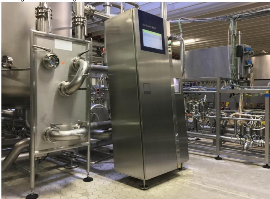
Auf dem von Hubl gefertigten Gehäuse können keine Flüssigkeiten stehen bleiben und der Bildschirm ist leichter abzulesen (Bild: Dausch).
