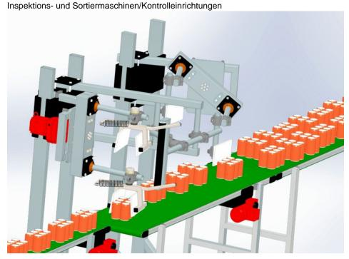
Servoantriebe sorgen für einen dynamischen, an Eigenschaften und Position des Produkts angepassten Sortiervorgang (Bild: Sortec).
