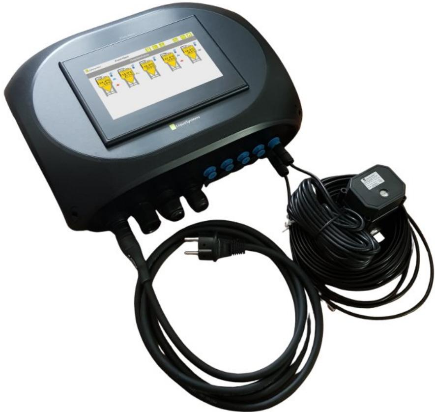
Das neue Gärsteuerungssystem ermöglicht die kontrollierte Prozesskühlung von bis zu fünf Tanks (Bild: Liquosystems).
