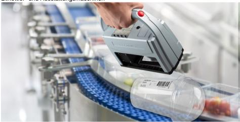
Das mobile Kennzeichnungsgerät ist für die Abläufe in der Lebensmittelindustrie vorbereitet (Bild: Ernst Reiner GmbH & Co. KG).
