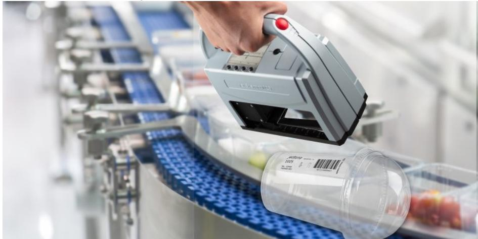
Das mobile Kennzeichnungsgerät ist für die Abläufe in der Lebensmittelindustrie vorbereitet (Bild: Ernst Reiner GmbH & Co. KG).
