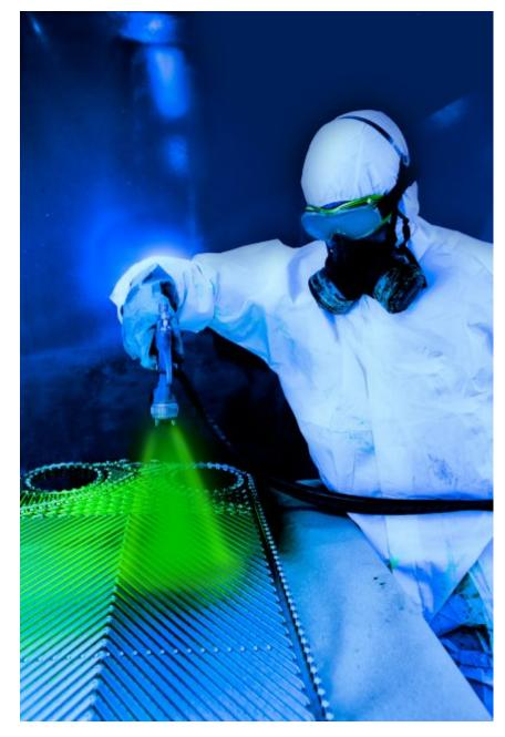
Im neuen Servicecenter werden z. B. Plattenwärmetauscher auf Risse und Deformationen geprüft (Bild: Alfa Laval).
