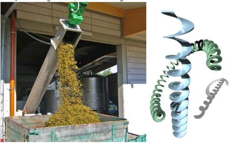
Die achsenlosen Förderanlagen werden mit biegsamen oder starren Förderspiralen realisiert (Bild: Wildfellner).
