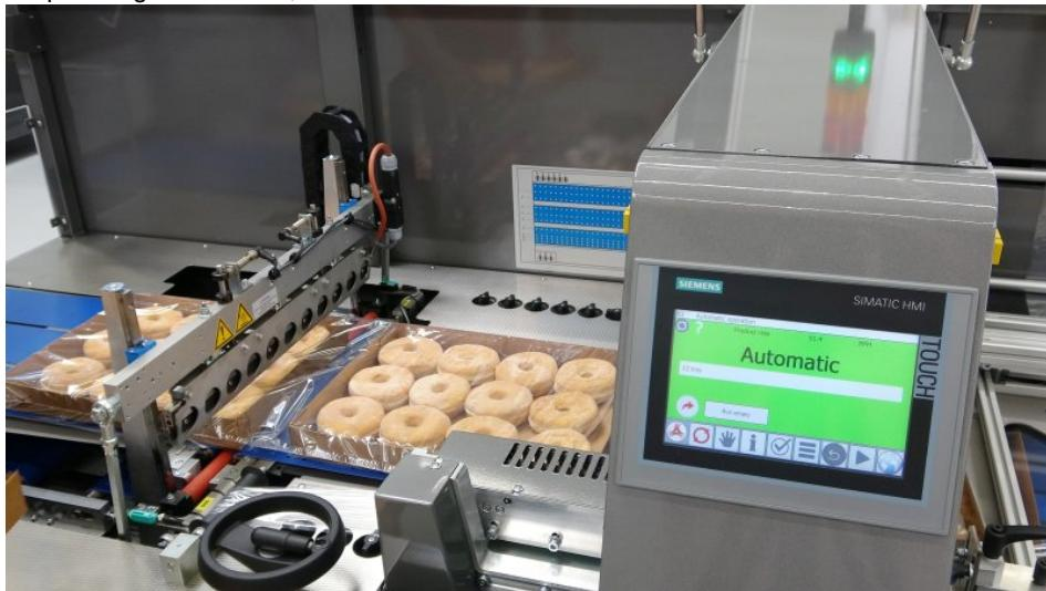
Die automatische Seitenschweißmaschine sorgt bei Backwaren für eine wirtschaftliche Frischeverpackung (Bild: Kalfass).
