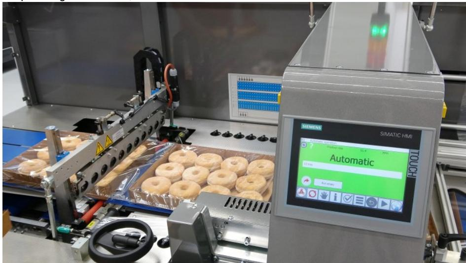
Die automatische Seitenschweißmaschine sorgt bei Backwaren für eine wirtschaftliche Frischeverpackung (Bild: Kallfass).
