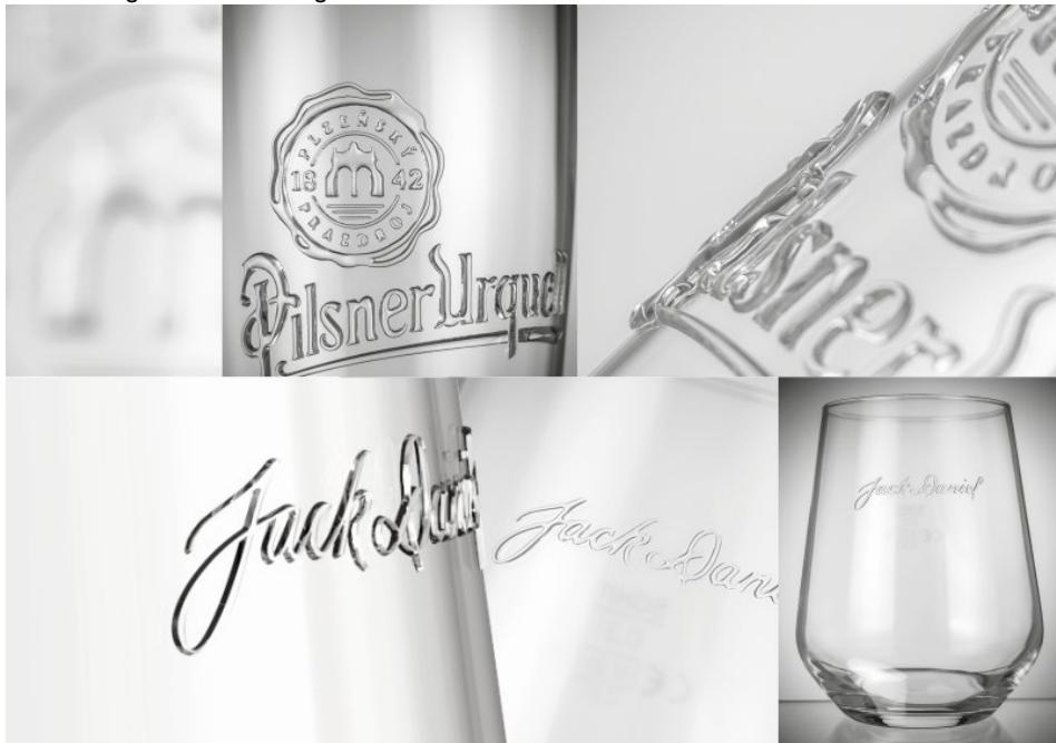
Der digitale Reliefdruck ermöglicht die individuelle Fertigung von Klein- und Kleinstserien sowie Einzelgläsern (Bild: Sahm).
