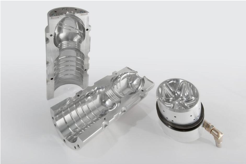
Der unabhängige Formenbauer produziert PET-Blasformen für alle gängigen Rundläufer- und Linear-Blasmaschinen (Bild: Kiefer).
