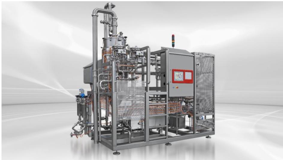
Die UHT-Anlagen bieten eine Vielzahl wählbarer Funktionen und eine Leistung von 100 bis 6000 kg/h (Bild: Karl Schnell).
