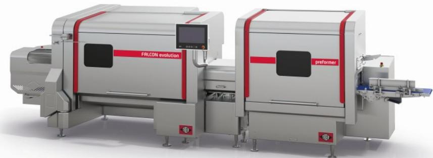
Der Vorformer ergänzt den Portionenschneider für hohe Ausbeuten und minimale Give-Aways in hoher Geschwindigkeit (Bild: Treif).
