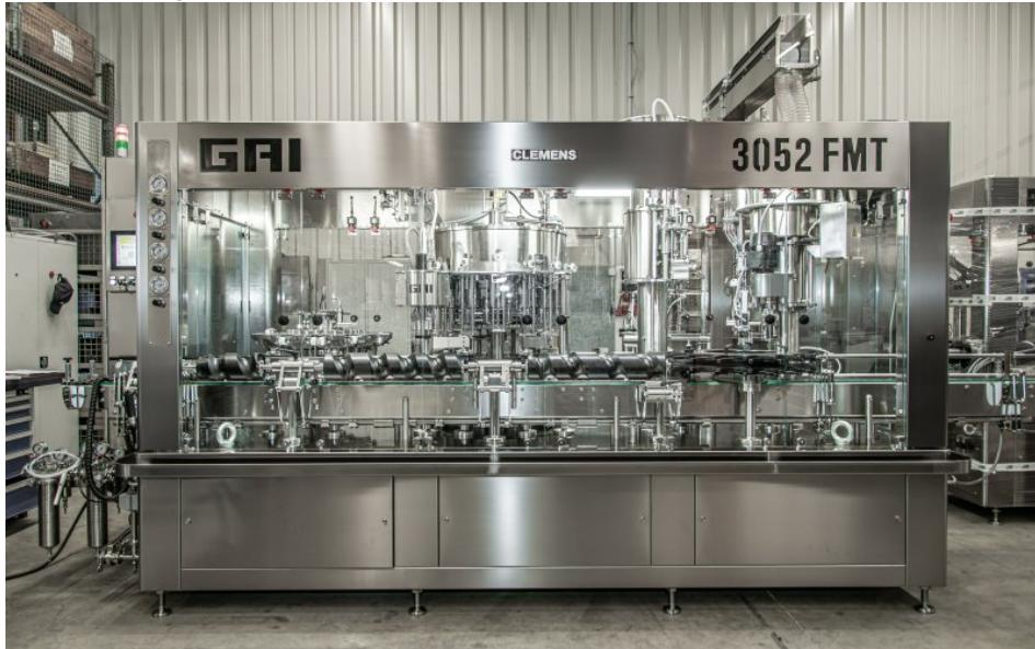
Der vollautomatische Monoblock spült, entlüftet, füllt und verschließt bis zu 3000 Flaschen Wein pro Stunde (Bild: Clemens).
