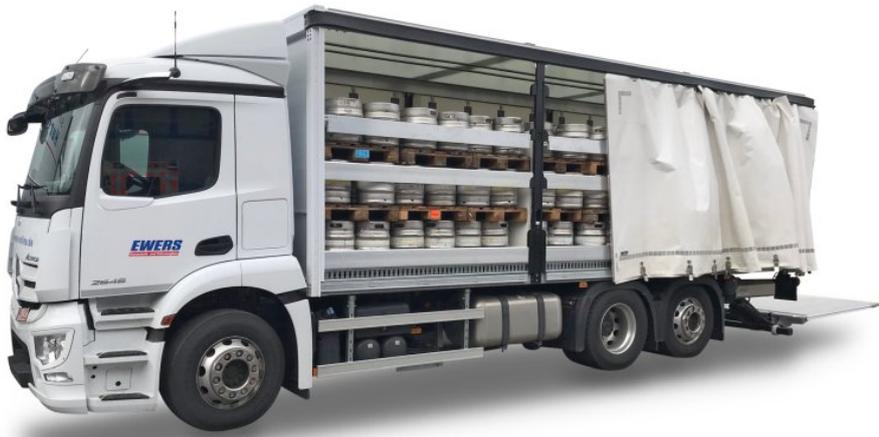
Der neue Schiebeplanenaufbau ist leichter und trägt daher zur Erhöhung der Nutzlast bei (Bild: Ewers).
