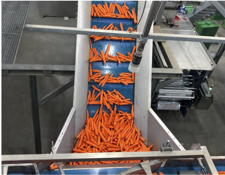
Nach dem Waschen werden die Karotten nach Größe und Qualität sortiert. Hier überwacht der Radarsensor die Füllstände in den verschiedenen Bereichen (Bild: Vega).
