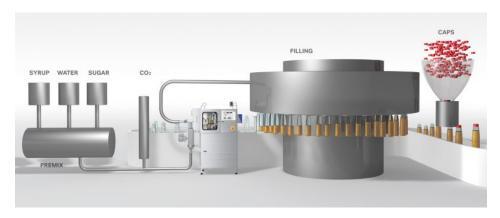
Die DMDC-Dosieranlage (Mitte) kann einfach in neue oder bestehende Abfüllanlagen integriert werden (Grafik: Lanxess).
