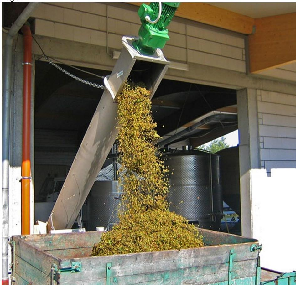
Die achsenlose Förderspirale ist das Thema von Wildfellner. Das Unternehmen entwickelt individuelle Fördertechnikkonzepte, die an die jeweiligen örtlichen Gegebenheiten angepasst sind, rund um den Transport von Schüttgütern. Realisiert werden sowohl horizontale und vertikale Förderverläufe als auch solche in Kurven und Bögen. Bei der Getränkeherstellung sind die Systeme beispielsweise für die Förderung von Wein- und Obsttrester, Maische, Trauben oder Äpfeln im Einsatz. In der
