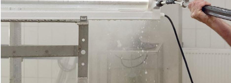
Die intensive Reinigung mit einem Hochdruckreiniger fordert Stabilität und hohe Dichtigkeit. Daher entsprechen viele der Norka-Leuchten für die Lebensmittel- und Getränkeindustrie der Schutzart IP 69K (Bild: Norka).
