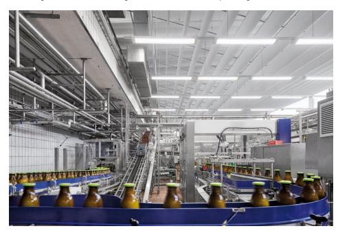
Beispiel für eine Beleuchtungslösung in einer Molkerei. Die Leuchten müssen bruchsicher, wasserdicht und leicht zu reinigen sein (Bild: Norka).
