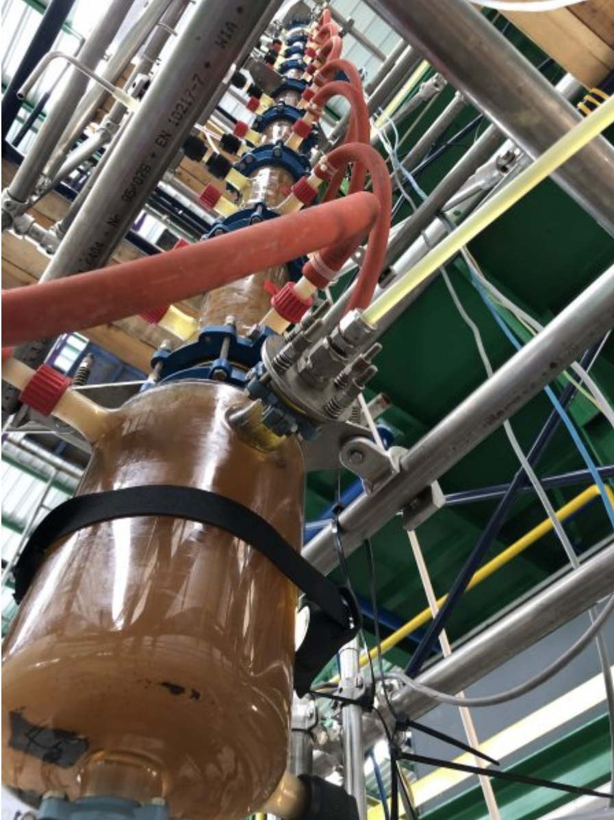
Die gerührte Extraktionskolonne unterstützte die Extraktion von Bio-Vanillin (Bild: Sulzer).
